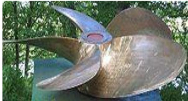
Abb. 46: Rechtsdrehender Schiffspropeller
