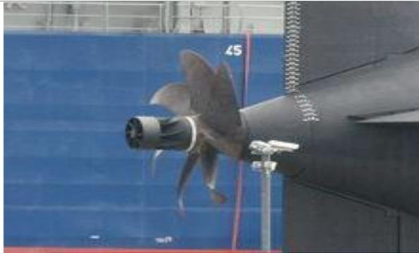
Abb. 49: Sichelpropeller an einem U-Boot der Klasse 214
