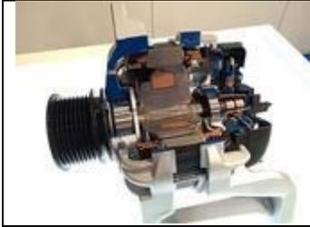
Eine **Lichtmaschine** ist ein elektrischer Generator – üblich ist ein Drehstromgenerator – der vom Verbrennungsmotor mit einem Riemen angetrieben wird. Die Lichtmaschine liefert den elektrischen Strom für Verbraucher und Starterbatterie.
