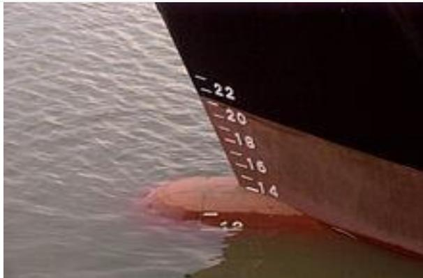
Abb. 3: Ahming am Bug eines modernen Frachters
